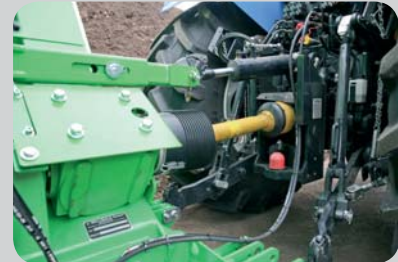
...► conexión a través de una eje de transmisión de alta potencia con embrague con protección de sobrecarga
